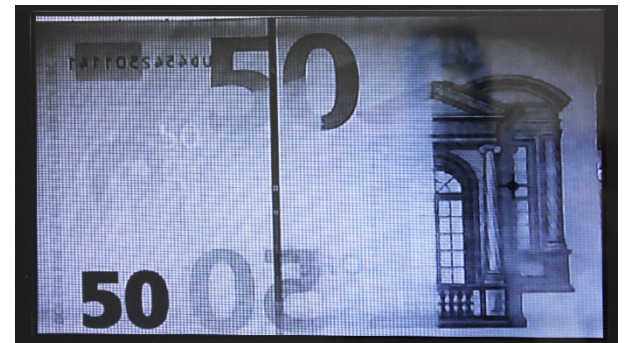
Anzeige der Banknote mit Filter: Wasserzeichen Display of the banknote with filter: Watermark
